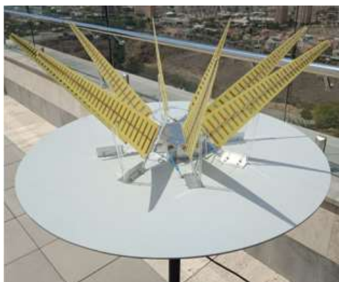
Рисунок 8. Собранный 8-элементная пеленгаторная антенная система.
